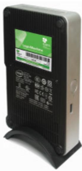
Свободно программируемый контроллер на базе Intel® NUC платформы.
